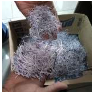
Gambar 2. Serat limbah spanduk flex banner dengan l/d = 80
