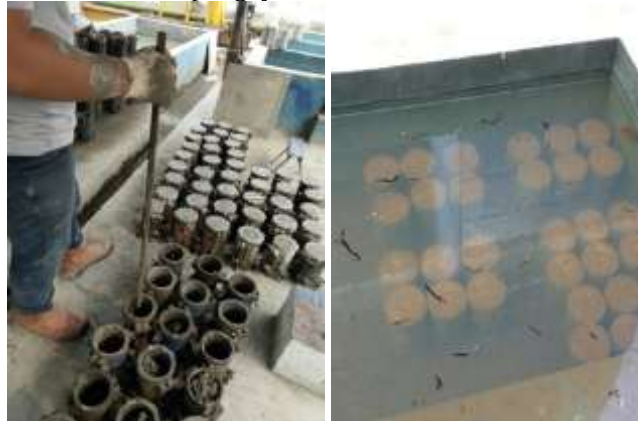
Gambar 4. Proses Pencetakan Benda Uji dan Perawatan Benda Uji
