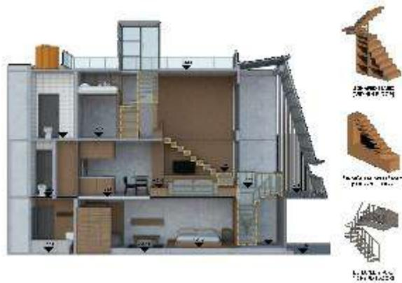
Gambar 13. Bentuk Sirkulasi Vertikal pada 3500mm House
